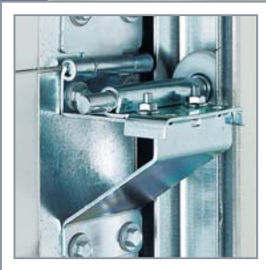
Charnière latérale galvanisée résistante avec support réglable et roulette en nylon avec roulements. Le réglage du support permet l'adaptation parfaite du tablier contre le joint de serrage.
